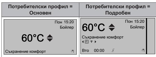
**За прочитане и регулиране на желаната температура на повторно подгряване (в програмиран режим и режим на повторно подгряване)**
